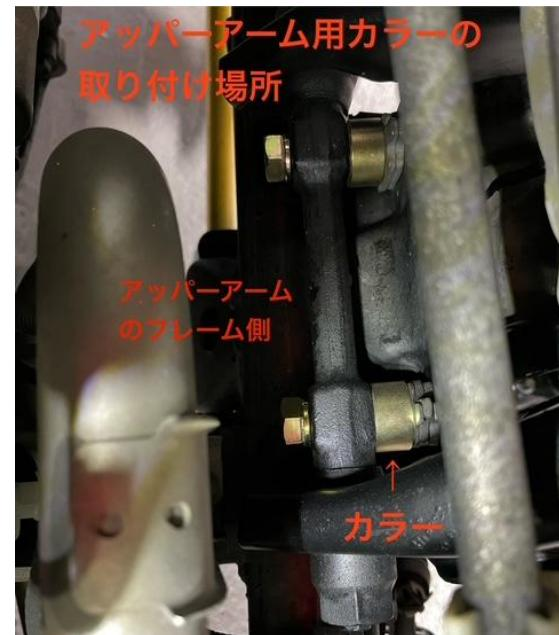
※アームとフレームの間に付属のカラーを入れることによって、アームの内側がフレーム側の溶接痕と接触しやすくなっていますが、アームがスムーズに上下するよう接触箇所をなくして下さい。
