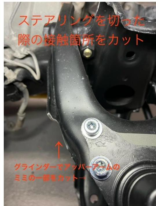
※すでにLSキャリパーなどのビッグキャリパーを取り付けられている場合は、ステアリングを最大に切った際にアッパーームとのミミの一部分が接触する場合があります。接触する場合は、ディスクグラインダーでミミをカットします。（※画像参照）ステアリングの最大の切れ角の目安は1回転半です。
