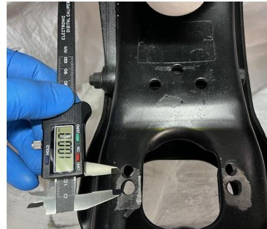
④ フレームに付いているバンプラバーマウントの先端を約15mm程度カットします。 （※画像参照）
