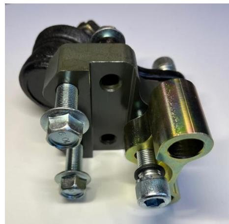
② テンションロッドは、移設に伴い長さが余るのでフレームへ固定しているナットとインナーカラーを厚みが薄い（短い）ものに交換し、取り付けます。
